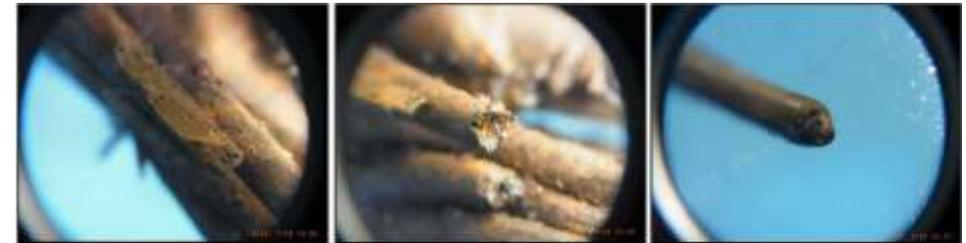
①応力腐食破断(60本) ②応力腐食破断(68本) ③しぼり破断(5本)
