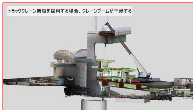
図-14 CIMモデルを活用した近接離隔確認
