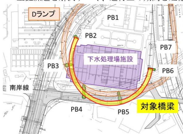
図-23 多軸台車を用いた一括架設対象橋梁
