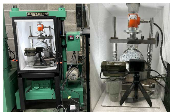
(a) 荷重試験機全体 (b) 荷重部の詳細 図-8 荷重試験の様子
