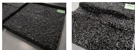
図-1 ホイールトラッキング試験後の供試体 左 : No.3、右 : No.6 (試験開始より 1.5 分後)
