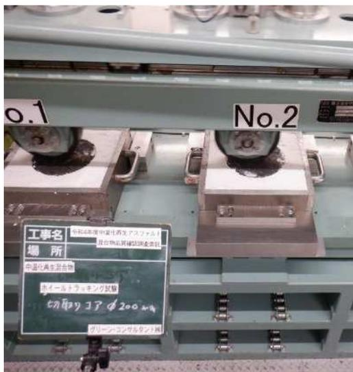
現場切抜き供試体によるホイールトラッキング試験
