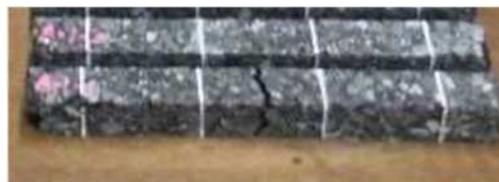
↑ 曲げ疲労試験供試体
