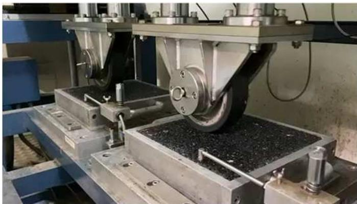
プラント練り落とし合材によるホイールトラッキング試験
