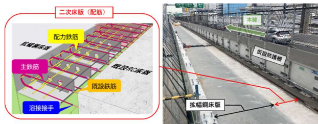
図-9 二次床版の配筋と打設後の状況
