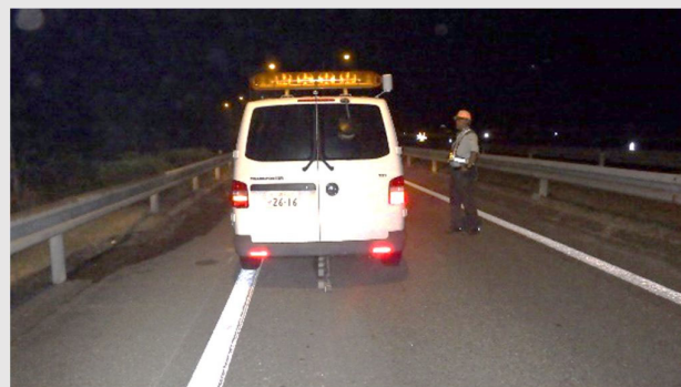
ランプ部でFWDを実施した状況
