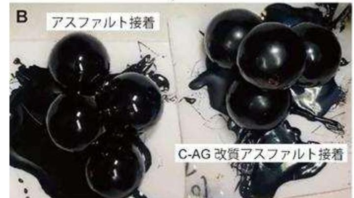
C-AG改質アスファルトの60℃における耐流動性は従来のポリマー改質アスファルトと同程度
