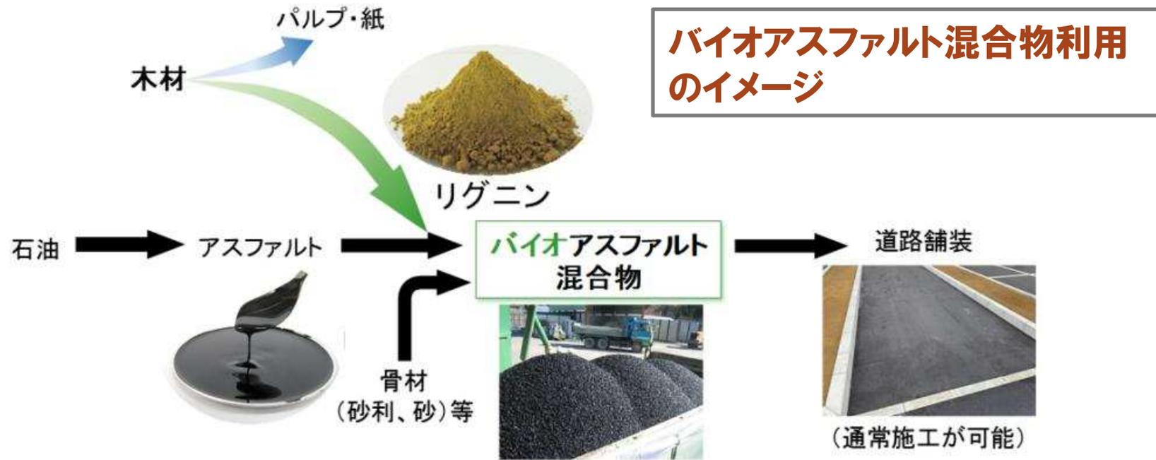
木材由来のクラフトリグニンをアスファルト舗装の原料の一部に利用することで、石油アスファルトの使用量を低減したバイオアスファルト混合物
