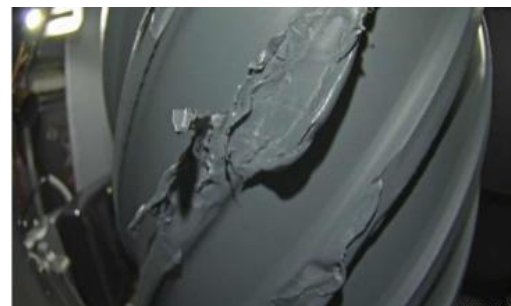
ケーブル登攀ロボットによるケーブル被覆の画像計測
