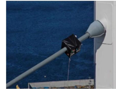
ケーブル登攀ロボットによるケーブル被覆の画像計測
