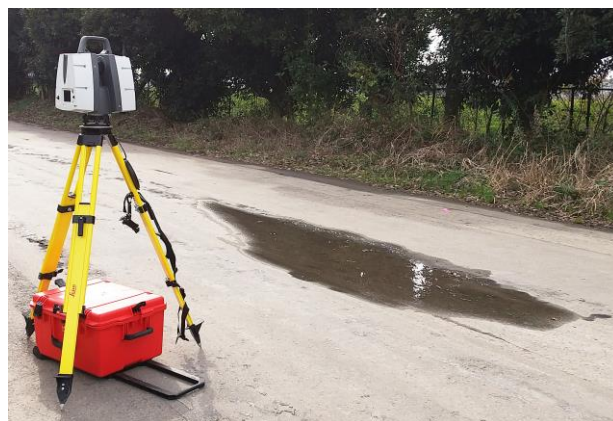
写真-1 水たまりがある領域の点群計測
