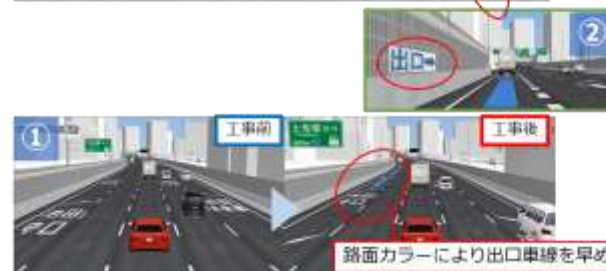
1号環状線(南行)リニューアル工事における案内標識および出口部のカラー舗装の施工例
