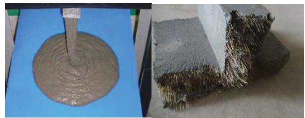
写真-5 UFC=超高強度繊維補強コンクリート
