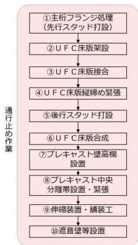
図-6 平板型UFC床版架設フロー
