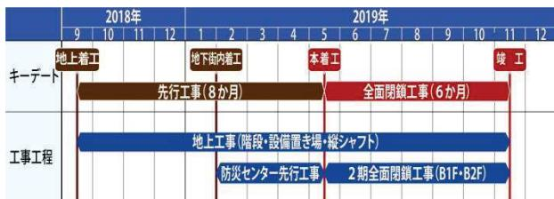
図6 リニューアル工事 構造工程
