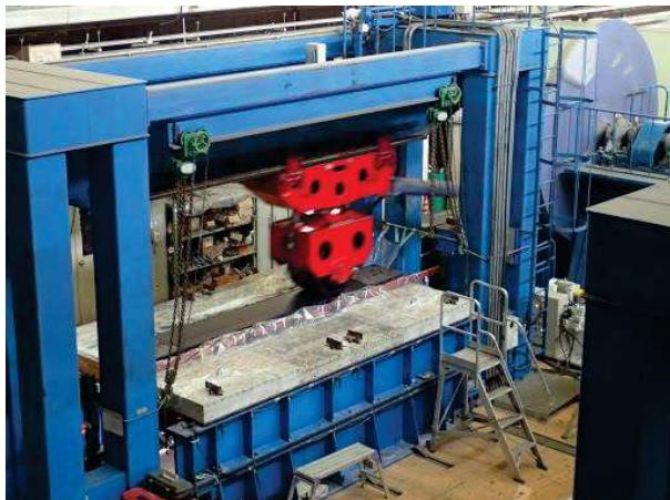
図-2 輪荷重走行試験(RC床版)
