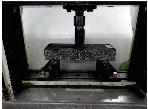
図-3 曲げ試験状況
