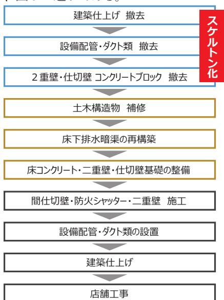
図9 スケルトン化工事 各ステップ
