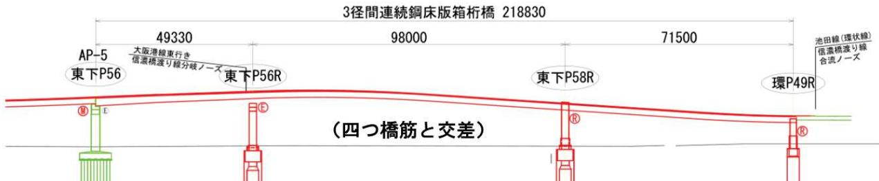
図-6 信濃橋渡り線を構成する3径間連続鋼床版箱桁橋
