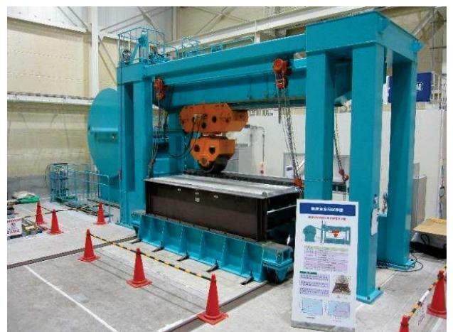
写真-1 輪荷重走行試験(鋼床版)
