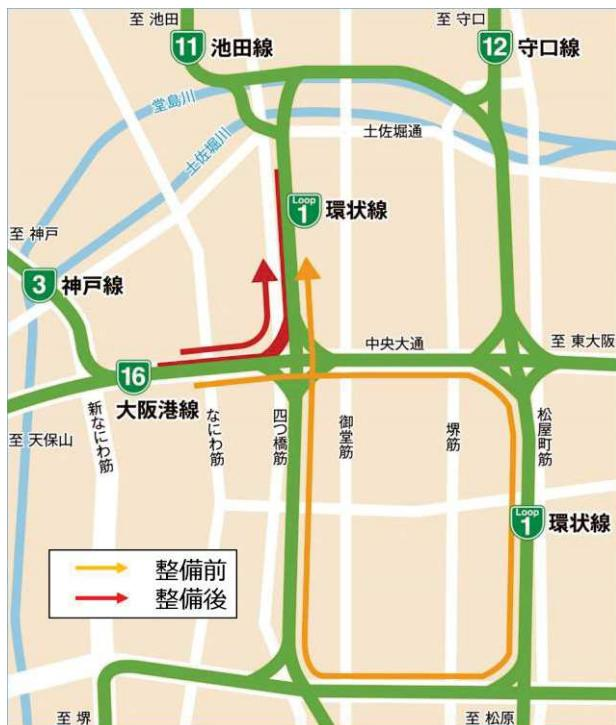
図-2 信濃橋渡り線整備前後のルート比較図
