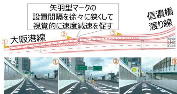
図-9 速度路面標示設置平面図
