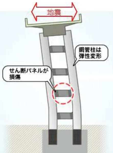
図-4 地震時の钢管集成橋脚の挙動
