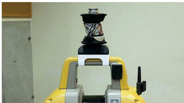
写真-2 ロックを取り付けた TLS (GLS-2000)
