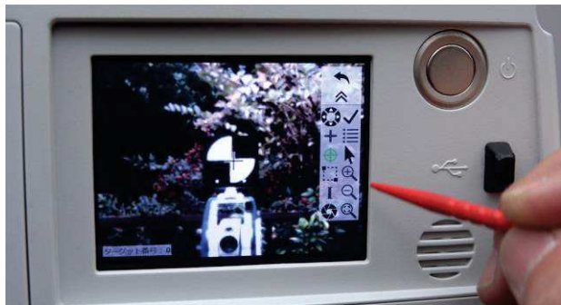
写真-4 標定点を測る TLS (Scan Station P40)
