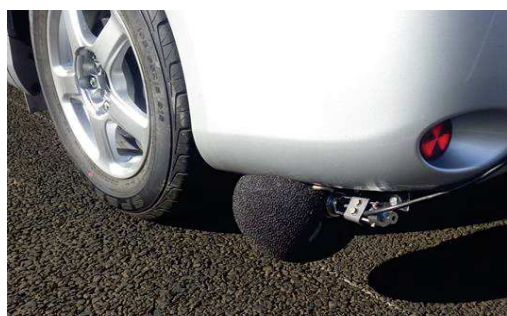
写真-1 タイヤ/路面騒音の測定位置
