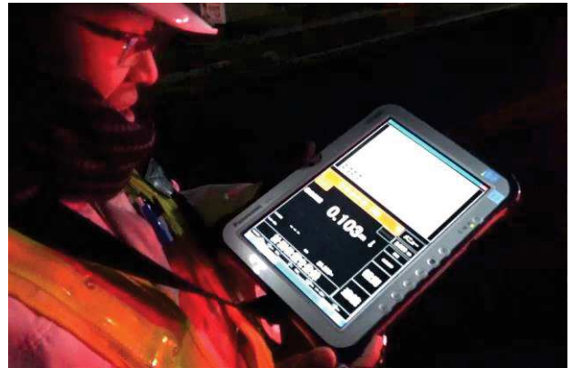
写真-4 タブレット端末で示す切削厚さの値
