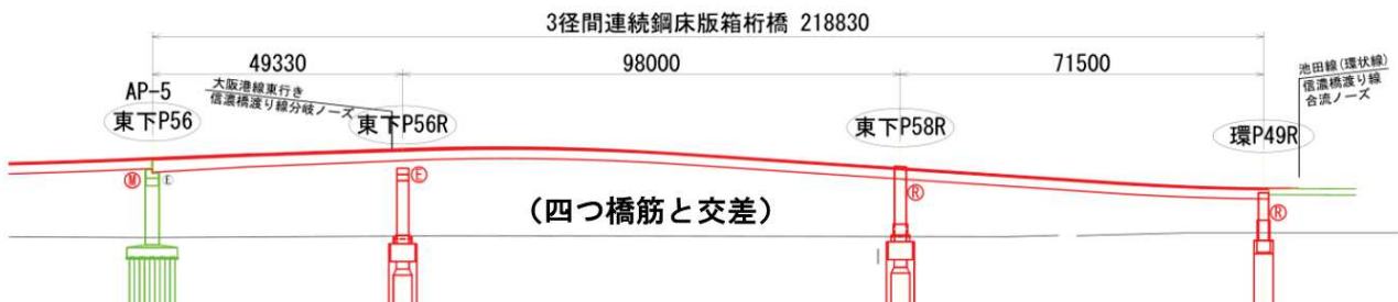
図-6 信濃橋渡り線を構成する 3 径間連続鋼床版箱桁橋
