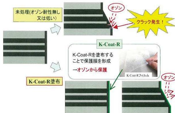
図-11 K-PRO 工法の概要
