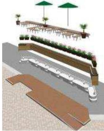
図-5 KOBE パークレットの構造
