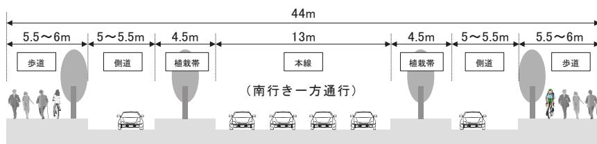
図-1 御堂筋の断面構成
