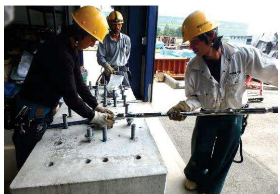
写真-2 Rアンカー抜取り試験状況
