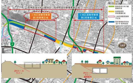
図-3 高規格堤防(スーパー堤防)との一体整備
