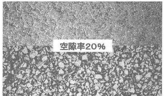
排水性舗装(ゴム樹脂系混合物の充填無)
