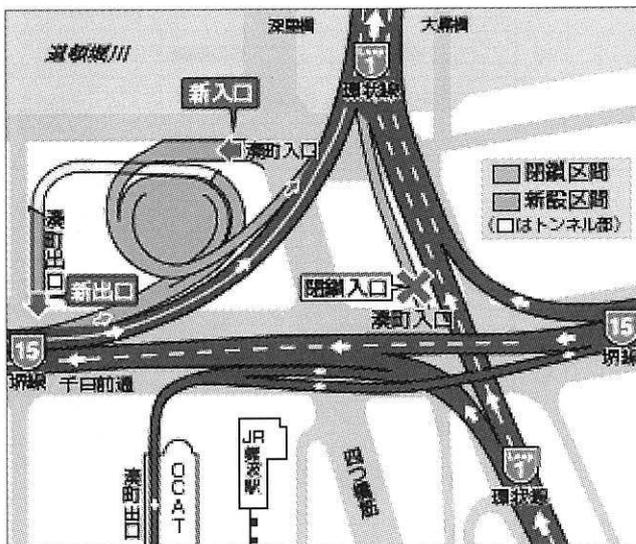
図-5 流出促進ランプの設置および入口の移設例 (湊町)
