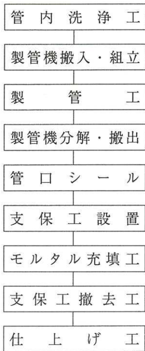
図-2 SPR工法施工フロチャート
