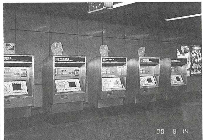
写真-14 地図を表示した地下鉄の自動券売機
