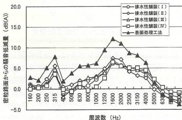
図-13 密粒路面からの騒音低減量 (併用7ヶ月、50km/h走行時)
