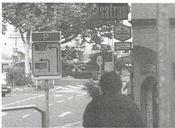
【写真-5】 STORMシステムの一つ駐車場案内システムの路上案内板。正面左方向に50台および40台収容可能な駐車場が二か所あることを標示している。
