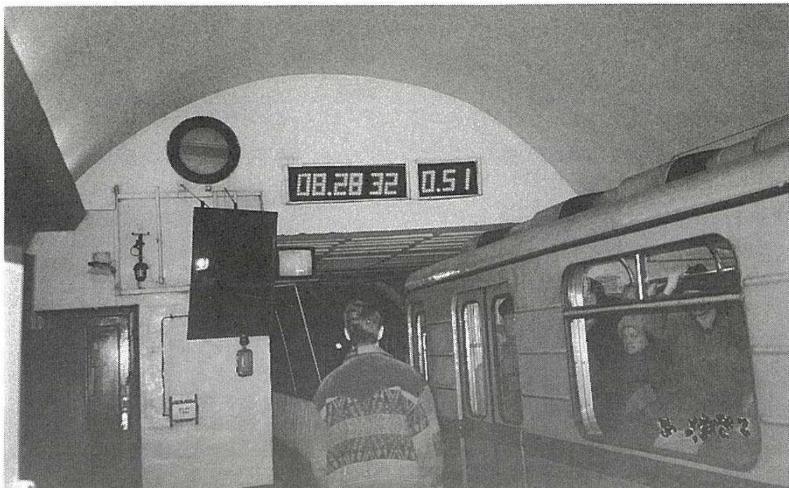
写真-5 地下鉄のホームの最先端部（上部の数字は左側が時刻、右側が先行列車が出発してからの経過時間を示す。51秒で次の列車が入ってきたことを示す）
