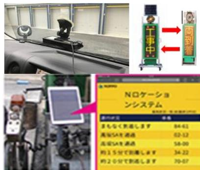
写真-5 GPS トラッカーと使用例
