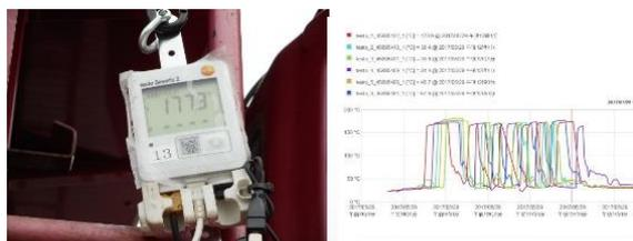
写真-4 Wi-Fi 温度計とデータ例
