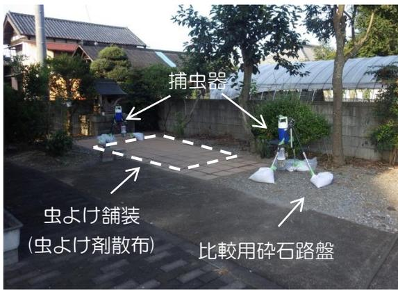
図-5 試験施工箇所
