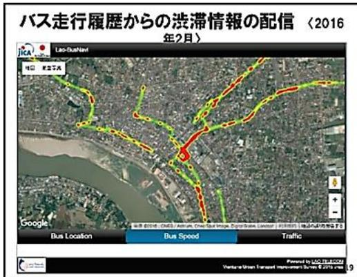
バスの位置情報を示しているだけだったら面白くないので、バスをセンサーにしまして、どこで渋滞が発生しているかという情報に加工して、一般利用者に見せます。一般の車が渋滞を避けてくれると、バスの定時運行に繋がるだろうということで、このような情報をWEBで提供を行っています。さらにこの情報表示ディスプレイをバスの運行管理センターに置きまして、渋滞が激しいときは追加のバスを出すとか、次のバスの運行時間の調整をするという運行管理をされています。この方が運行管理責任者です。
