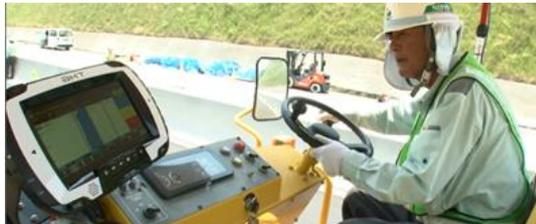
写真-6 新型転圧管理システムの使用状況
