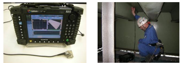
図-3 フェイズドアレイ探傷機と検査状況
