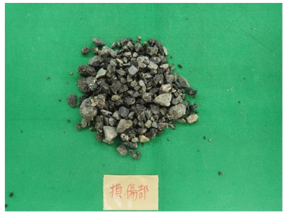
写真-4 抜き取り調査後の基層
