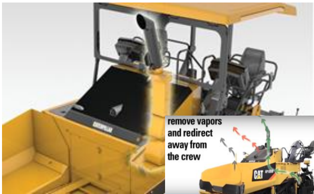
(b) アスファルトペーバーの対策
