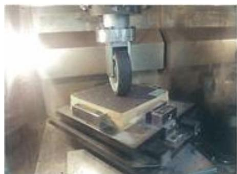
写真-2 繰り返し表面剥離試験状況
