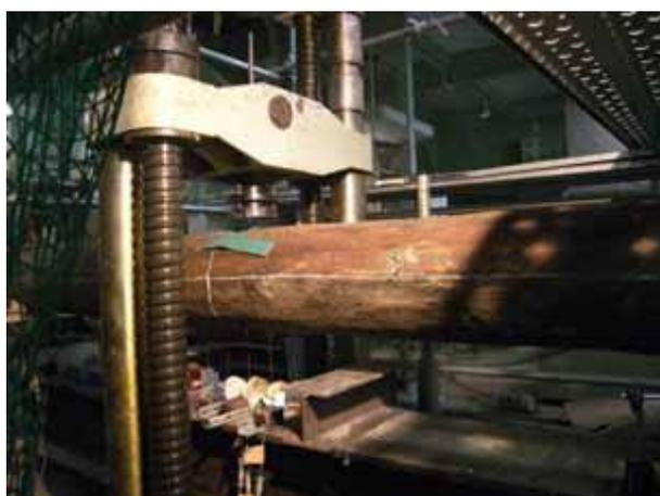
写真-5 木材の材料試験(曲げ強度試験)
