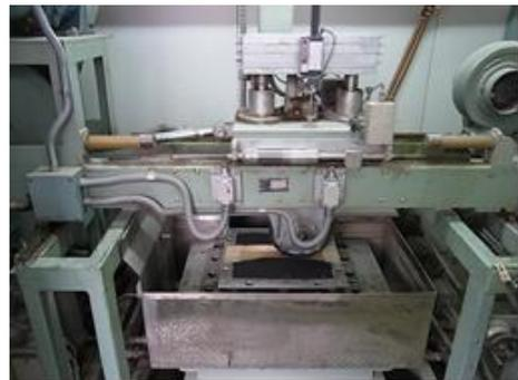
写真-1 ホイールトラッキング試験状況
