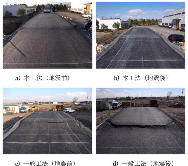
写真-5 東北地方太平洋沖地震前後の路面変形状況 2011年3月9日に実施した250mm沈下実験後の状況をa)およびc)、3月11日地震後の状況をb)およびd)に示す。
