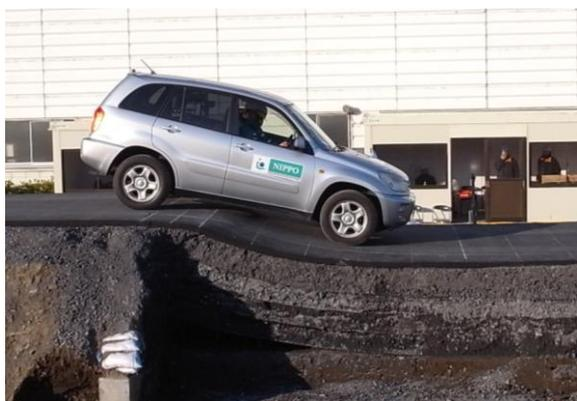
写真-6 車両走行実験状況 (RV車：沈下量 550mm)
