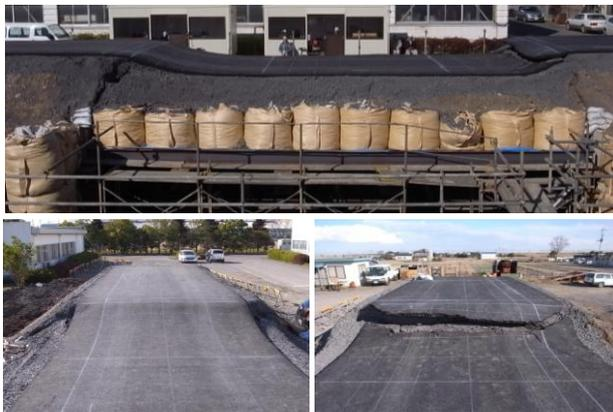
写真-4 本工法と一般工法の路面変形の比較（沈下量550mm；写真左下：本工法，右下：一般工法）
