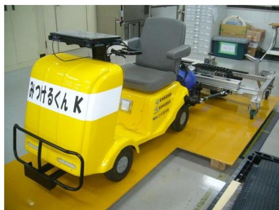
写真2 鋼床版検査装置の外観
