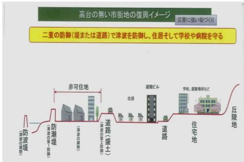
図－２ 多重防災の概念図(石巻市)
