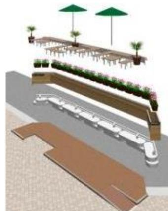
図-5 KOBE パークレットの構造
