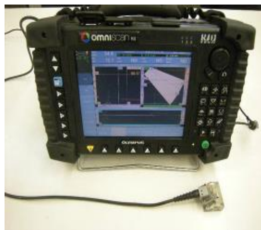
図-5 フェイズドアレイ探傷器 デッキ貫通き裂
