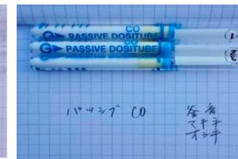
写真8 測定後の一酸化炭素用パッシブドチューブ
