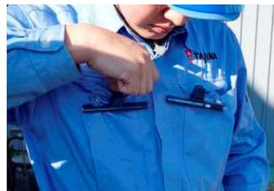
写真1 パッシブドサンプラーの取り付け状況 一酸化炭素用と硫化水素用の2種類を3人の作業員の胸に取り付けた。
